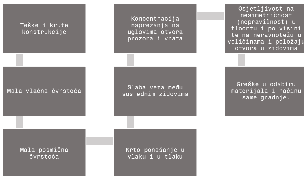
Slika 1.2 Prikaz glavnih nedostataka i razloga otkazivanja neomeđenog zida.
