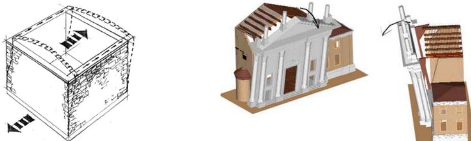
Slika 2.54 Povezivanje zidova s ciljem osiguranja nerazdvajanja visokih zidova [5]
