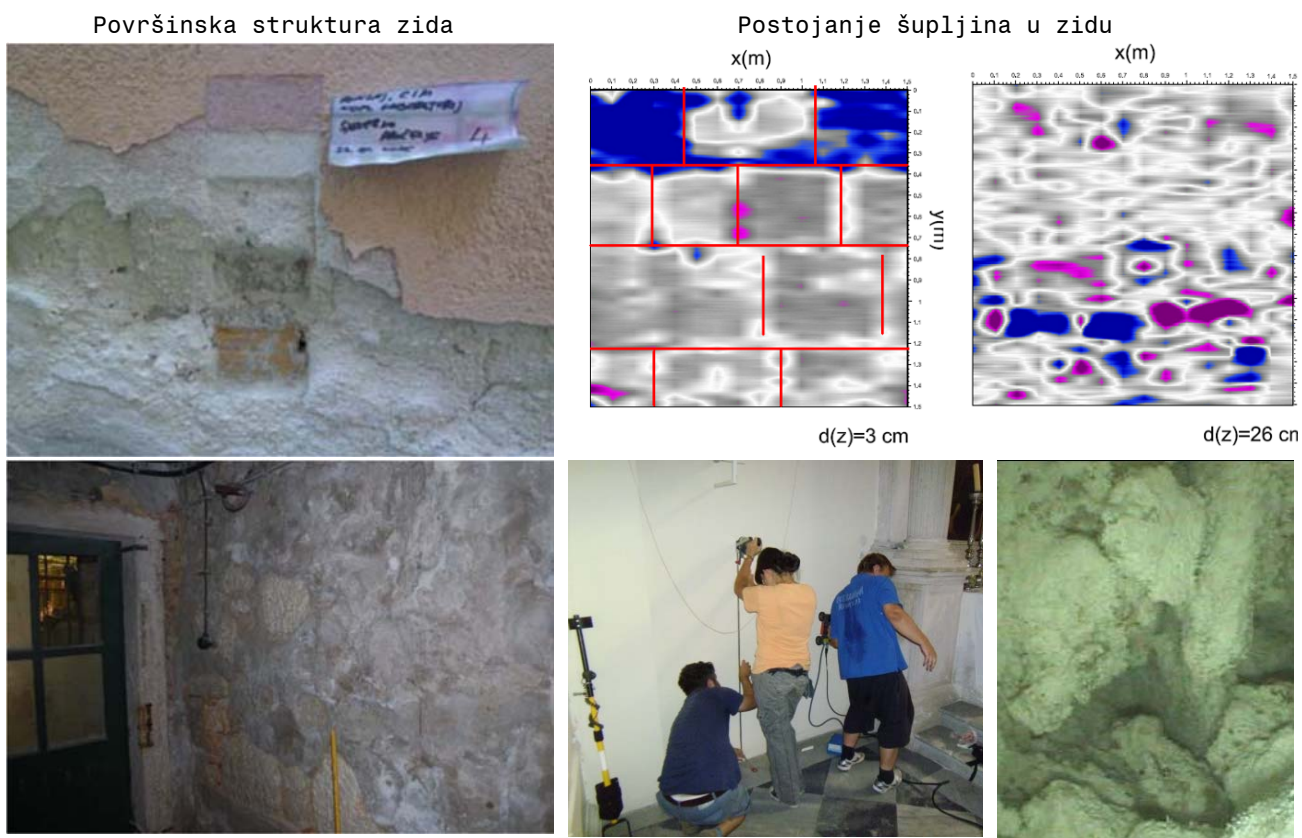
Slika 3.11 Fotografija površinskog ispitivanja strukture zida i prikaz simulacije šupljina
