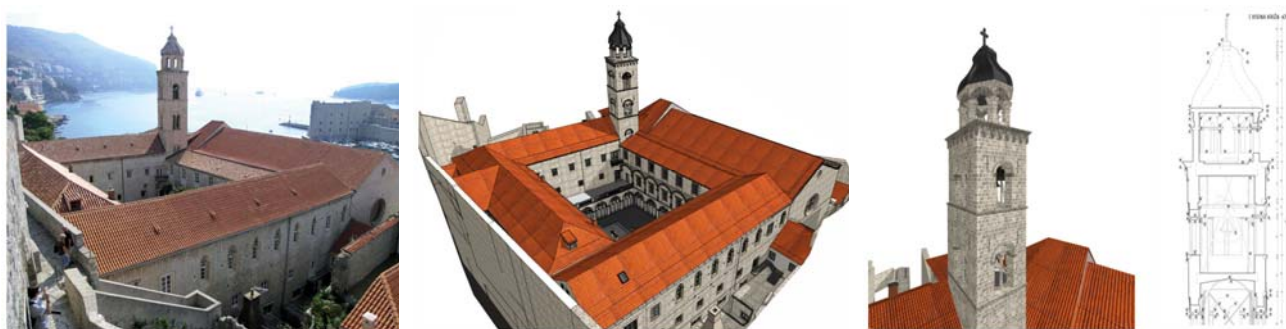
Slika 3.5 Prikaz skenirane građevine i izrađenog 3D modela iz kojeg je moguće izraditi 2D nacрте
