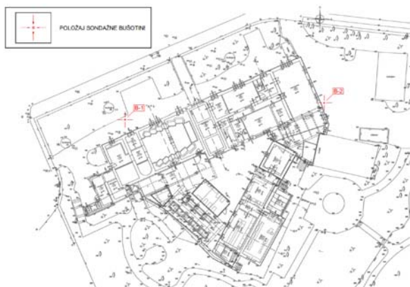
Slika 3.9 Prikaz pozicija bušotina i njihova izvedba
