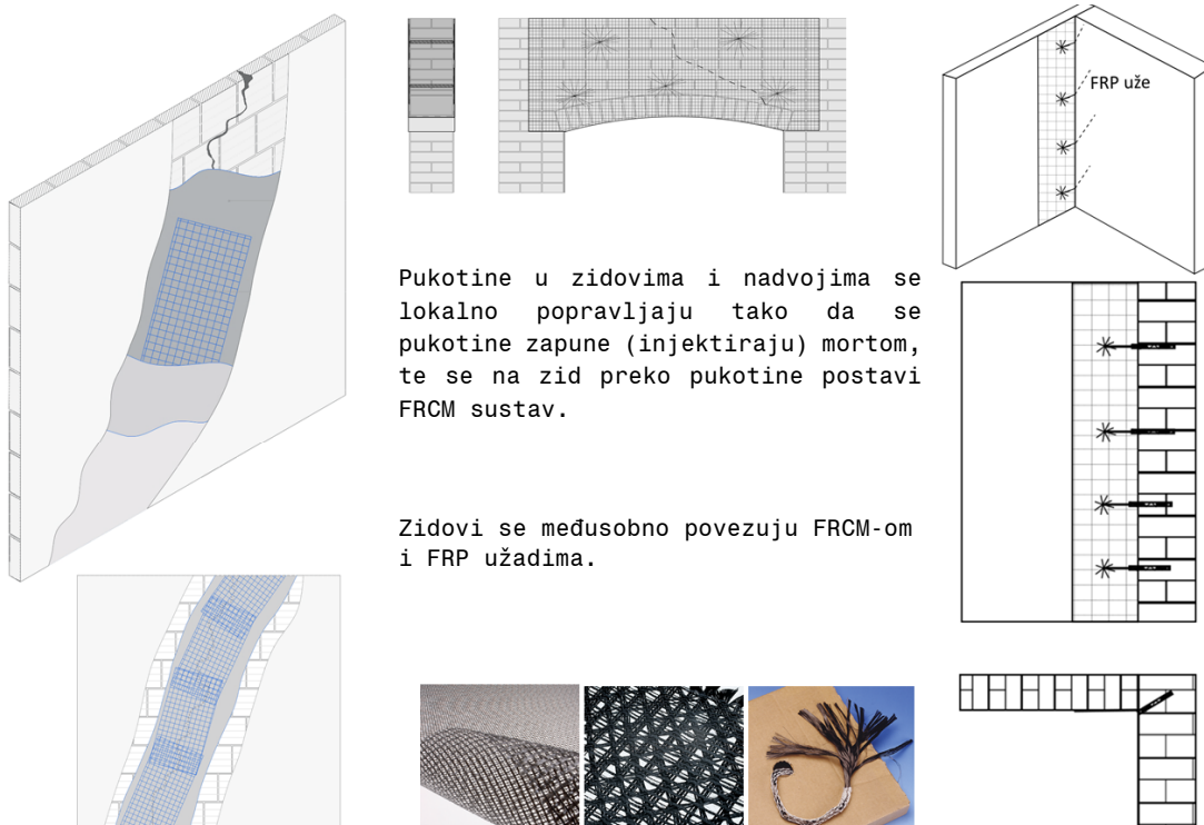
Slika 2.75 Saniranje pukotine (pojačanje) i povezivanje zidova FRCM sustavom
