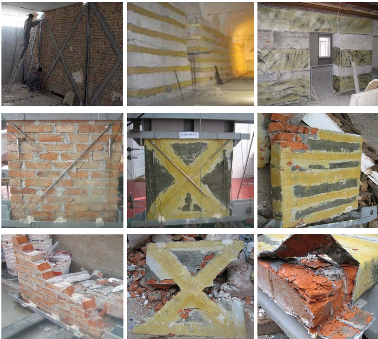
Slika 2.83 Primjeri pojačanja lamelama i trakama i njihovog ispitivanja
