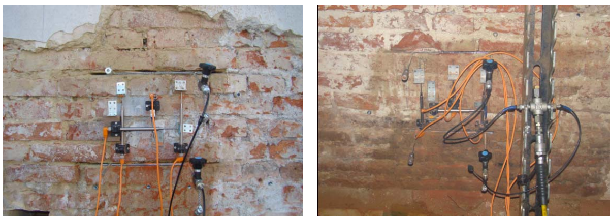
Slika 3.12 Fotografija ispitivanja vlačne čvrstoće i modula elastičnosti zida
