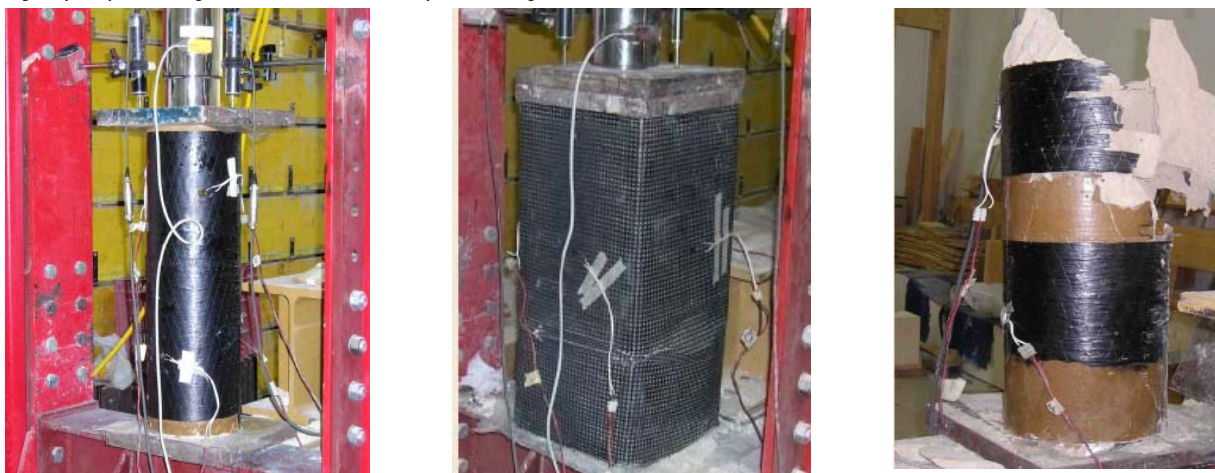
Slika 2.84 Primjeri ispitivanja ovijenih stupova
