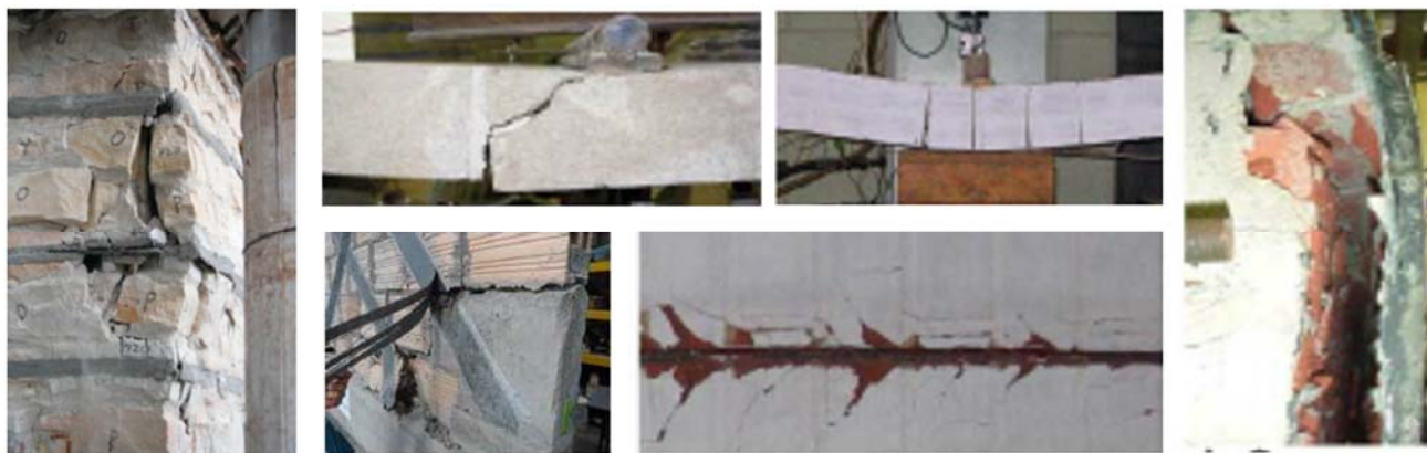
Slika 2.5 Načini otkazivanja ziđa pojačanog FRP-om [2]
