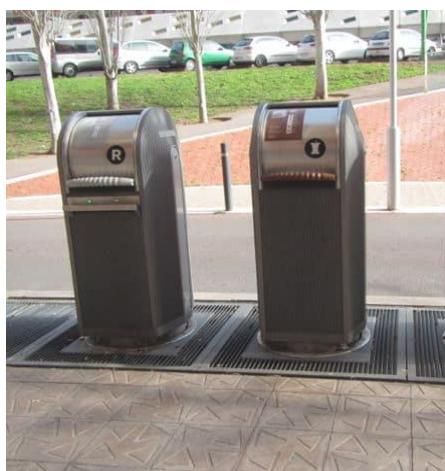
Slika 14. Smart kante za smeće. Putem WiFi-a i radio frekvencije, senzor daje podatke središnjem sustavu o razini smeća u kantama, te sanitarni djelatnici tada mogu planirati najoptimalniju rutu i vrijeme za odvoz smeća
