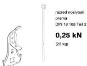
Ankerfix sidreni ovjes s osiguračem 0,25 kN za CD profil 60 x 27 žica s ušicom
