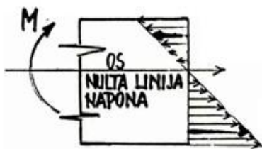
Slika 7.4. Prikaz djelovanja momenta savijanja i posljedično linearno promjenjivih normalnih naprezanja po visini presjeka
